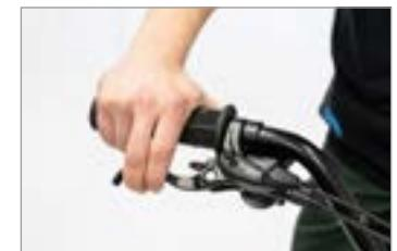
Durch das Lösen der Innensechskantschraube an der Lenkerschelle kann der Bremsgriff auf dem Lenker verschoben werden. Eventuell müssen Sie zuerst mit einem passenden Innensechskantschlüssel auch die Motor-Bedieneinheit bzw. Schalteinheit lösen und verschieben.
