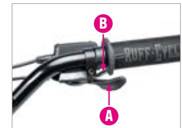
**Bei längerem Stillstand:** Schalten Sie in den größten Gang (kleinstes Ritzel) um die Seilzüge bei längerem Stillstand zu entlasten.
